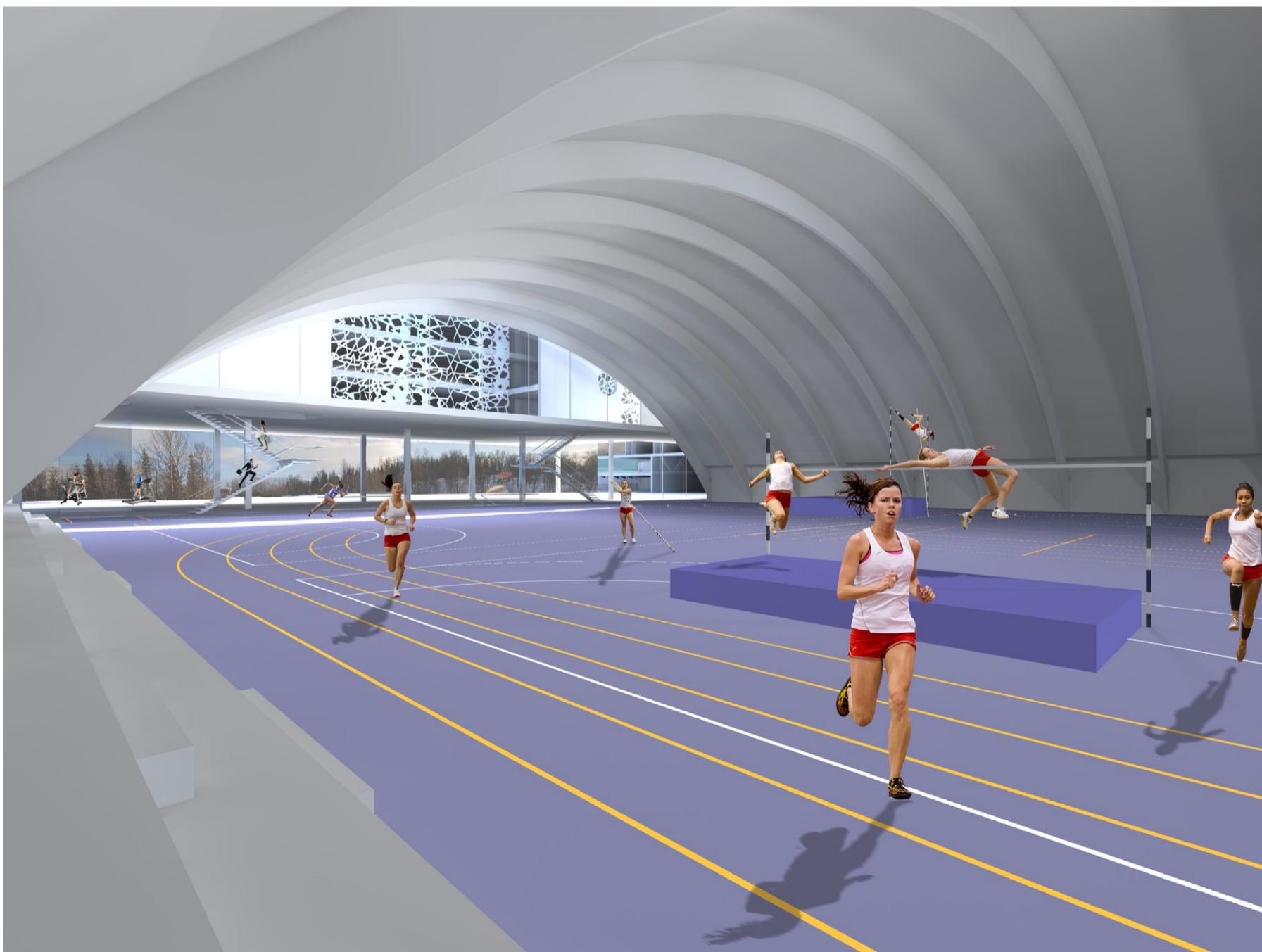
Friidrettshall - utvidelse og ombygging av Tromsøhallen. Løpebanen har doserte svinger, i svingen som ikke er på bilde er det en fast dosert sving, den på bilde er hydraulisk, og vises her i nedfelt posisjon. Hallen er en flerbrukshall med 3 håndballbaner. I bakgrunnen ser vi internforbindelsen med 110m løpebane, treningsstudio, kontorfløy o.l.
